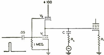
Fig. 17—The double triode clamp.
